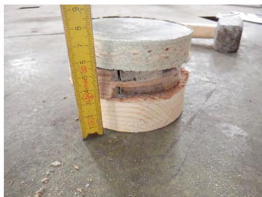
Abb. 18: Bohrkern Bodenaufbau 1. OG
