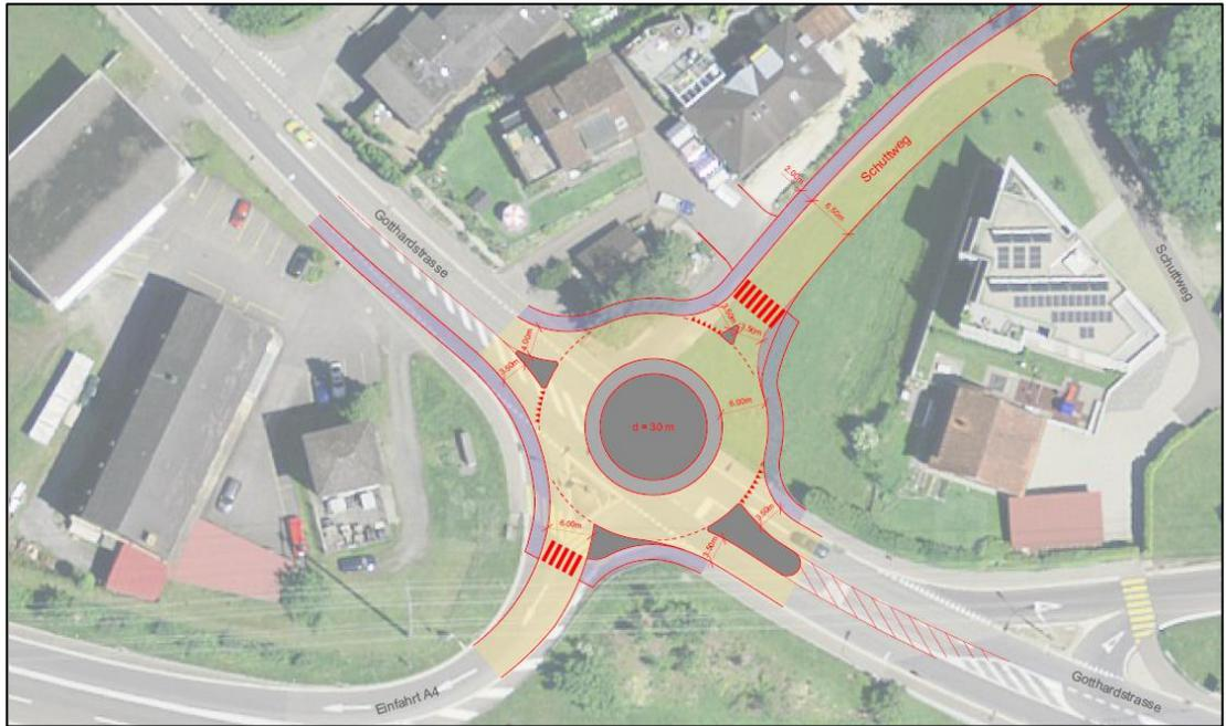
Abb. 38 Situationskizze Z3.2 Kreisel Nord (Gotthardstrasse / A4-Einfahrt Richtung Zug / Schuttweg)
